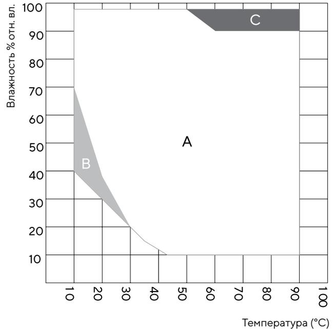
A: Диапазон регулирования температуры и относительной влажности.
