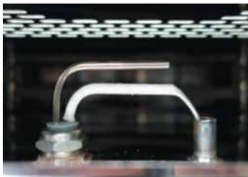
Для климатических испытаний, требующих диапазона влажности и температуры, выделенного красным на графике возможно использовать психометрический датчик.
